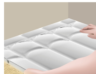
PRZYKLEJANIE PŁYTY PODŁOŻE DREWNOPOCHODNE
