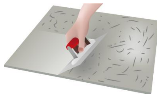
USUWANIE NIERÓWNOŚCI - BETON
